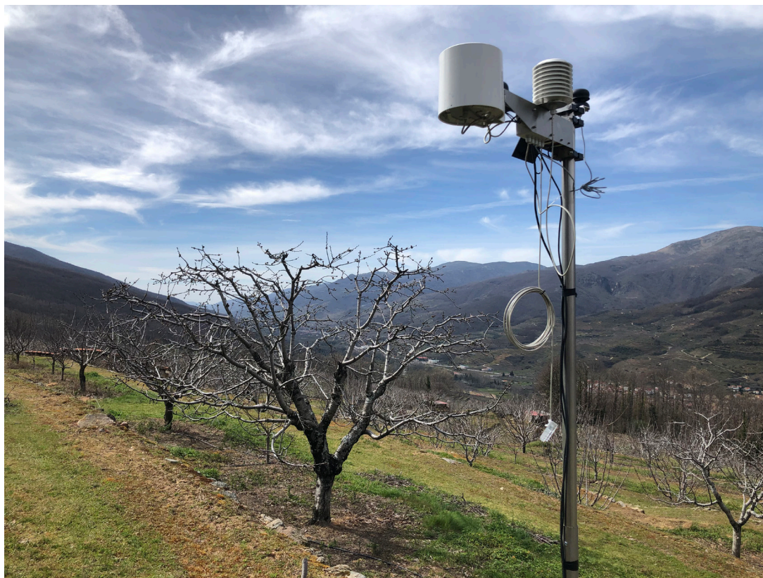
Imagen 5: Estación agroclimática en el cultivo de cerezo en condiciones de montaña en el Valle del Jerte
