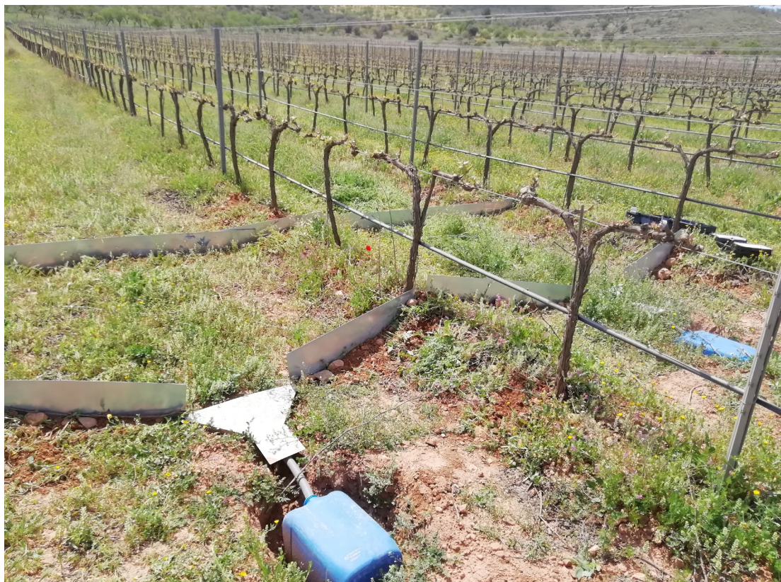
Imagen 1: Mediciones en viñedo. Parcela de erosión cerrada 5 m2
